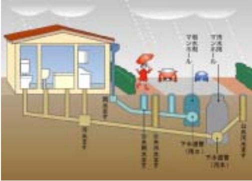
(図3・分流式下水道)
