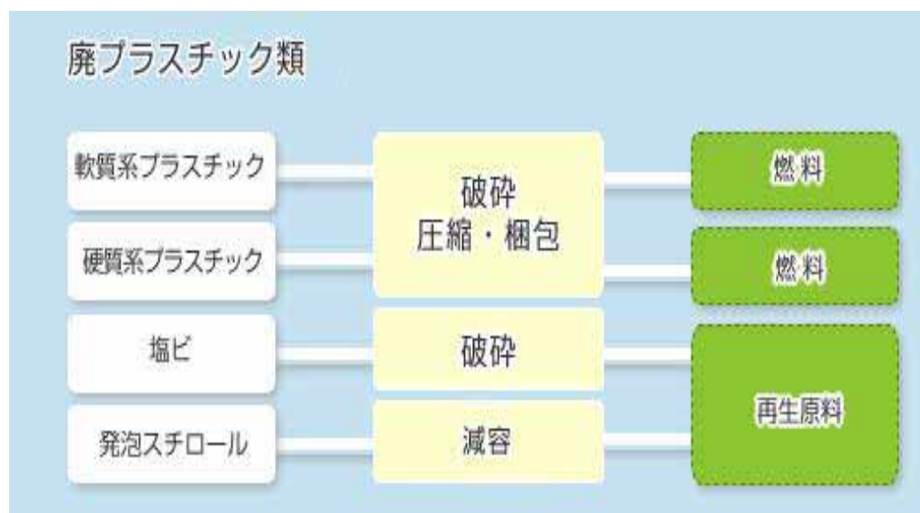
図D プラスチックの処理の流れ
