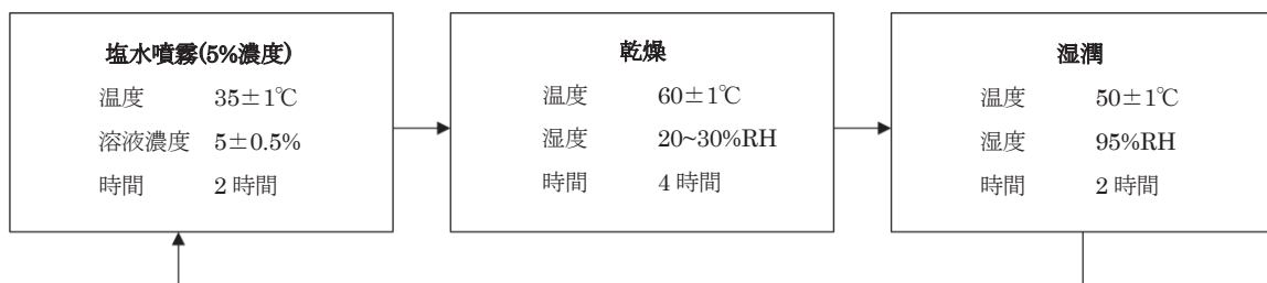
図3 促進腐食試験サイクル条件
