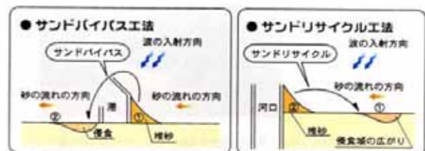
図-4.2 海岸侵食（浜の減少）の対策例（国土交通省 HP）
