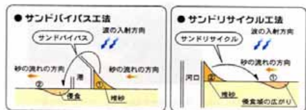
図-4.2 海岸侵食（浜の減少）の対策例（国土交通省 HP）
