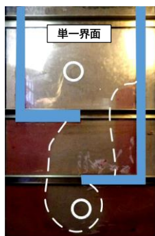
写真-4 地下埋設物を想定した単一界面 活性剤と間隙内二液反応発泡法との比較
