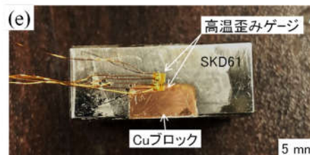
Fig. 9 (a)冷熱試験装置の組立図, 採用した(b)赤外線集光加熱器, (b)出力制御器, (c)温度・歪み計測器, (d)試験片
