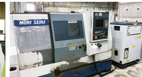
ターニングセンタと高圧クーラント装置
