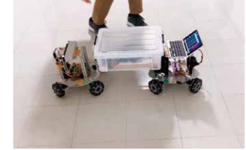
2台の移動ロボットによる協調搬送実験
