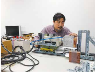
微破壊(小径ドリル型削孔)試験
