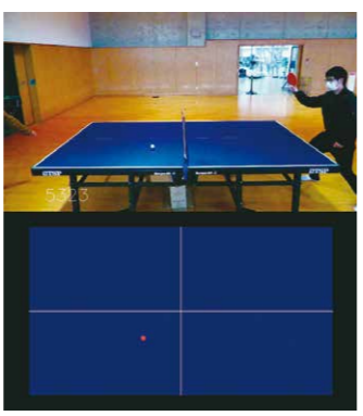
加速度センサによる卓球ボールのバウンド位置計測例: 上は入力画像、画像処理によりバウンド位置がリアルタイムに計測される。
