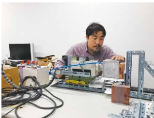
微破壊(小径ドリル型削孔)試験
