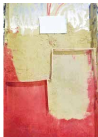
間隙内二液反応発泡での浄化(写真-3)
