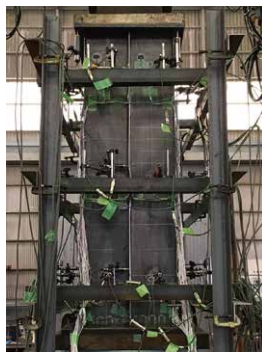
SBHS500製補剛短柱の圧縮試験
