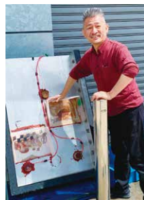
油汚染地盤作成前の土槽(写真-1)
