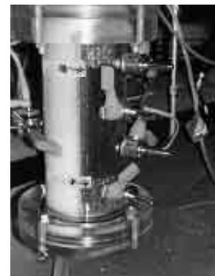
図-3 土柱法最下端カラムの油面・水面設定部
