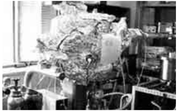
微細金属人工格子製膜微細加工装置 「装置ベーキング中」とは装置を熱して真空容器の内壁に付着している不純物などを飛ばして真空度を良くすることです。
