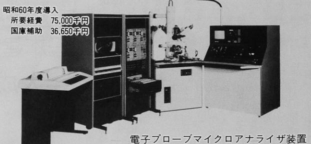
電子プローブマイクロアナライザ装置
