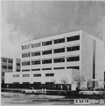
標として設計されている。1、2階を占める建設工学科の実験エリアは、吹き抜けの大空間を特徴とし、2階部分を研究準備室としている。実験ゾーンは、構造・材料・水理の3分野から成っており、天井走行クレーンを設置し、実験の利便をはかっている。地下に設けられる構造用実験ピットは、100t/㎡の荷重に耐えるよう設計されており、土木・建築のあらゆる構造実験が可能である。また、材料実験エリアは、恒温槽をはじめ電子顕微鏡等最新機器の設置が予定されている。また、水理実験室は、長さ35m×幅7.7m×高さ6mのスペースを有し、いずれもこの種の実験施設の中ではトップレベルの施設となっている。3、4階は、化学、物理学教室の実験室、研究室であり、大同校舎から移転することとなる。これによって、教養系各教室が、滝春・白水地区に集結することとなる。5階には、心理学教室の実験室、研究室、教職課程の研究室、さらに一般講義室が配置される。
