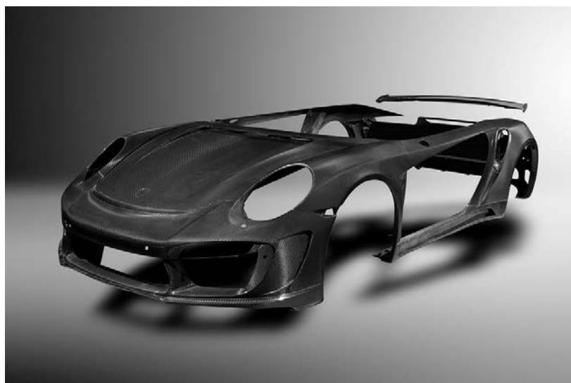
図 5.1.7 一体成形されたポルシェ 911 の CFRP ボディ
