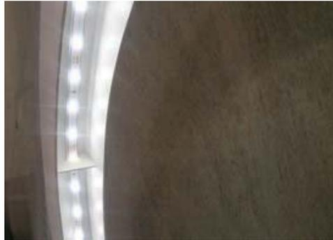
光源として、テープ状のLEDを使用した。テープ状のLEDを使用することにより、今まで取り付けることが出来なかった、湾曲した面にも光源を取り付ける事が可能になる。また、面に光源を取り付ける事により、端に向かって暗くなる事はなく、全体的に明るく灯す事が出来る。
