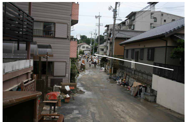
写真-4 愛宕橋左岸伊賀町の被災地(白線は痕跡水位)
