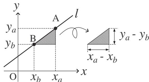
直線の ( $x$  軸からの) 傾き  $\alpha = \frac{y_a - y_b}{x_a - x_b}$  (上図で  $x_a - x_b$  と  $y_a - y_b$  がどこの長さに対応するかにも注意!)
